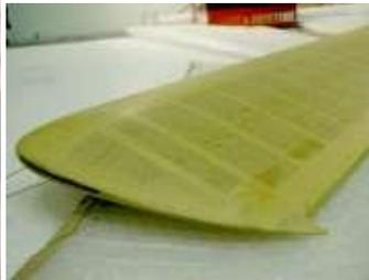
Vient maintenant le temps du séchage. Il doit impérativement être effectué sous contrainte. Les pièces doivent être
